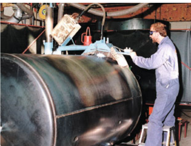
Boden aufsetzen auf der Rundschweissanlage
