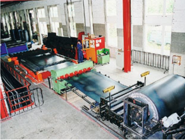
Das Mantelblech wird vom Coil abgerollt
