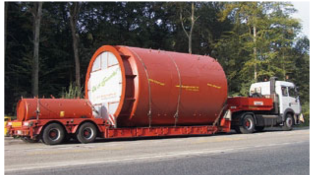
60 000 l Solarspeicher für Schulanlage
