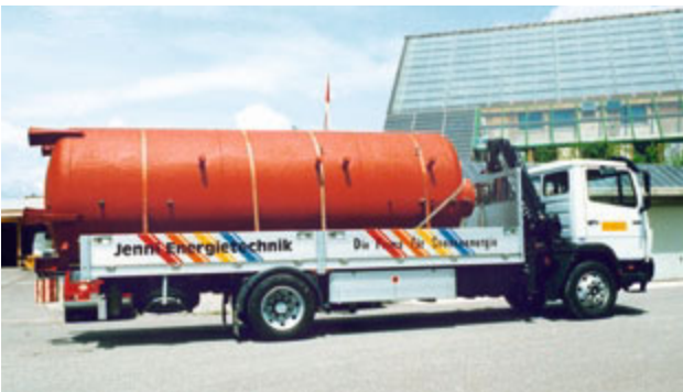
15 000 l Solarspeicher für Hochdeckungsgrad-Anlage
